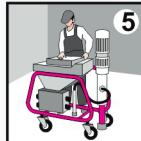
При механизированном нанесении смесь приготавливается в машинах для перемешивания и подачи штукатурного раствора. Сухую смесь засыпать в бункер штукатурной станции. Произвести регулировку подачи воды (количество воды определяется типом штукатурной машины) для соответствия требуемой консистенции раствора (ориентируясь на показатель подвижности Пк3).
