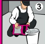
Для подготовки раствора залейте водопроводную воду комнатной температуры в чистую ёмкость из расчёта 5,0 - 5,7 л воды на 1 мешок (25кг).
