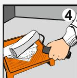
4 Нанесите краску на поверхность кистью, валиком или распылением в два слоя с промежуточной сушкой не менее 2 часов. Через 24 часа после нанесения последнего слоя возможна эксплуатация покрытия в щадящем режиме, через 14 дней покрытие приобретает окончательную прочность.
