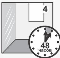
**4** При проведении работ и в течение последующих 48 часов  $t^\circ$  воздуха и основания не должна опускаться ниже, чем  $+5^\circ\text{C}$ . Рекомендуемая влажность основания не более 10%.
