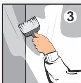
**3** Перед началом работы клей тщательно перемешайте. При склеивании изделий нанесите клей кистью или валиком тонким слоем на одну из склеиваемых поверхностей. Поверхности выдержите под давлением до полного высыхания (не менее 24 часов).
